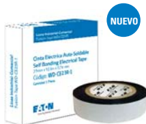
WD-CE23R-1 Cinta eléctrica auto soldable de EPR (Etileno Propileno) Brinda aislamiento eléctrico hasta 800V 9m x 19mm Sello contra la humedad en instalaciones eléctricas Buen rendimiento para empalmes por encima o debajo de la tierra Disponible en color: Negro
