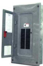
CCR24T -Gris CCR24TW -Blanco 24 Circuitos 3 Fases 4 Hilos 240V~ ó 48V.C.D.; 60 Hz. Gabinete tipo NEMA 1
