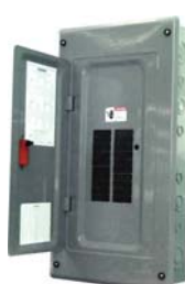
CCR20T-Gris 20 circuitos 3 Fases 4 Hilos 240V~ ó 48V.C.D.; 60 Hz. Gabinete tipo NEMA 1
